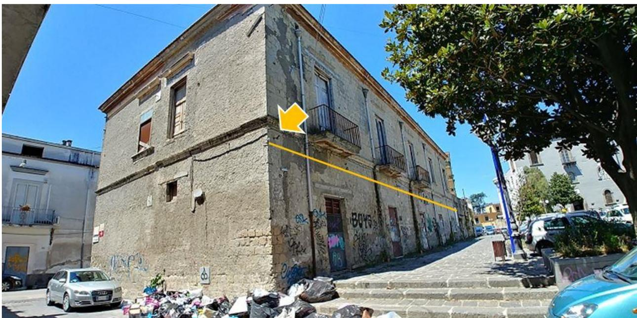
Questo è uno dei fabbricati antichi che si affacciano in piazza C. Battisti che non sono mai stati ristrutturati e dove è ancora possibile trovare testimonianze di staffe a muro con isolatori in ceramica dove passavano i cavi elettrici per illuminare le case. Lungo la linea gialla al di sopra delle porte del piano terra sono sistemate staffe a muro con o senza isolatori che costituivano l'impianto esterno elettrico del fabbricato.
