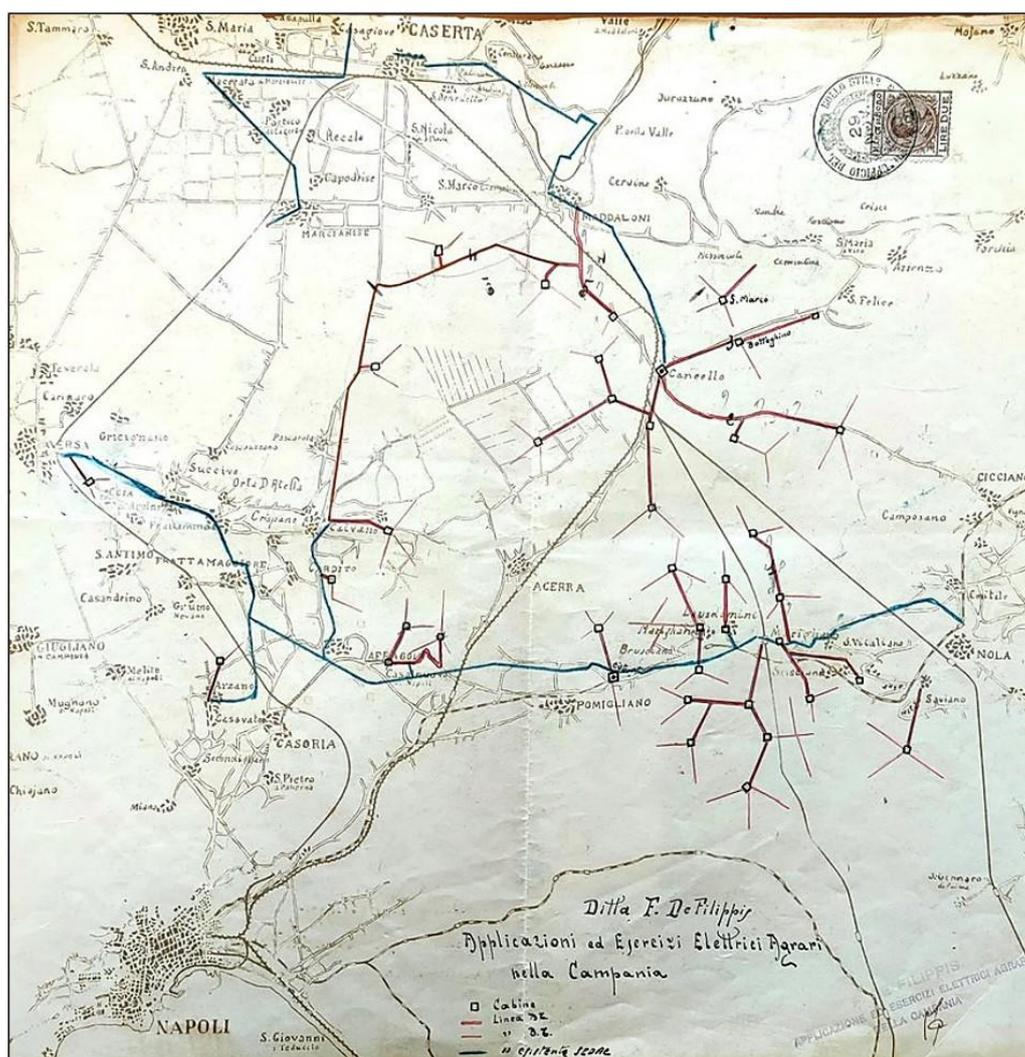
Pianta delle linee elettriche esistenti ed in progetto per la distribuzione di energia elettrica per l'azionamento delle macchine agricole e degli apparecchi di sollevamento di acque in vari Comuni fra cui il Comune di Caivano.
